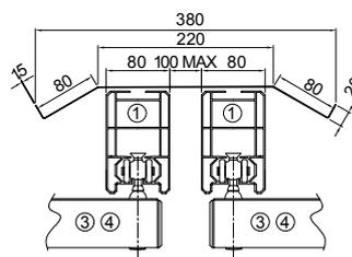
Tôle de recouvrement, double guidage
