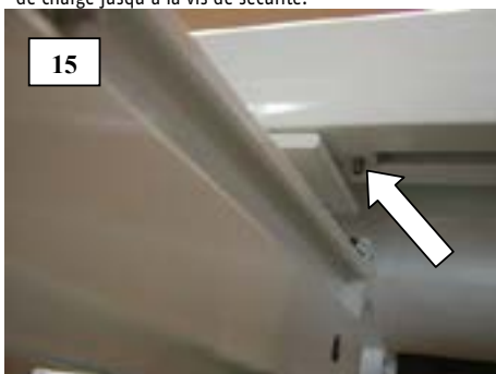
15 Une fois la barre de charge alignée, il faut protéger son support au niveau de la coulisse de guidage gauche (voir côté intérieur, d'en bas) à l'aide d'une vis à six pans creux (de 3) pour éviter qu'il ne glisse.
