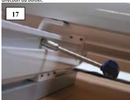
17 Démontez les vis de sécurité des deux coulisses de guidage à l'aide d'une clé à douille de 10 mm.
