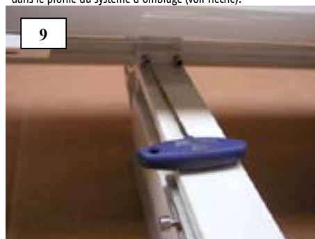
9 Fixer le bloc de sécurité au niveau de chaque support de boîtier à l'aide d'une clé imbus 6.
