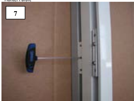
7 • Mettre en place les coulisses de guidage et serrer uniformément toutes les vis des supports (3 à gauche et 3 à droite de chaque support) (clé imbus de 3). • ATTENTION ! Les chariots sont toujours du côté gauche des coulisses de guidage.
