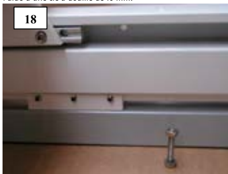
18 ATTENTION ! Avant de déployer le store pour la première fois, s'assurer que les vis de sécurité des chariots sont démontées des deux côtés des coulisses de guidage.
