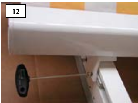
12 Fixer la barre de charge à chaque chariot (2 vis par chariot) à l'aide d'une clé imbus de 6 mm.
