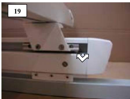
19 Déployer la barre de charge jusqu'au galet de renvoi et vérifier le jeu entre le chariot et le galet de renvoi (env. 1 cm, voir flèche).
