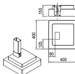
Socle en béton de 40 kg
