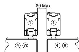
Tôle de recouvrement pour servir de cache pour des coulisses de guidage côte à côte
