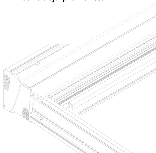
3.12.3 Suspendre la parclose par le haut et placer le dispositif d'étanchéité
