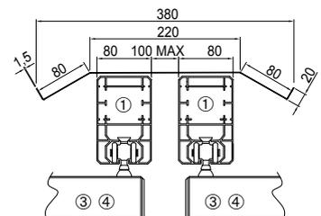
Tôle de recouvrement pour servir de cache pour des coulisses de guidage côte à côte
