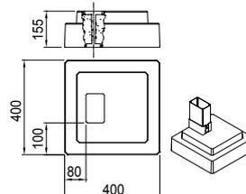
Socket en béton de 40 kg
