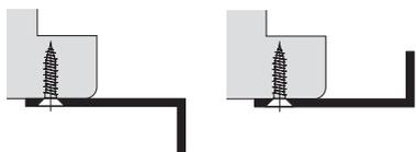
Avec les profilés angulaires (variantes correspondantes ou montage sur équerre), aucun perçage de montage n'est possible car en raison des différentes situations de montage (par ex. forme du rejet d'eau, recouvrement de dormant, etc.), il convient de déterminer au cas par cas les points de vissage. Le matériel de montage pour les profilés angulaires est joint à la livraison et comprend des vis SK 3,5 x 16 mm (15 08 35.16) et des pastilles adhésives (14 23 81) en quantités adéquates.
