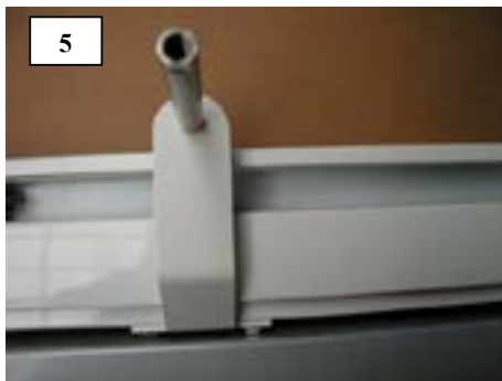
5 • Ab bestimmten Breiten oder Ausfällen ist die Montage einer Tuchstütze erforderlich. • Hierzu muss der Halter der Stütze vor dem Befestigen der Führungsschiene im mittleren Bereich zur Innenseite zeigend angebracht werden.
