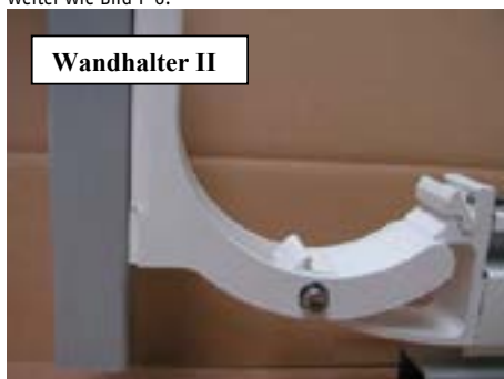
Verbinden Sie die Wandhalter und Führungsschienen miteinander (Innensechskantschraube M8x65 mit Mutter M8 und U-Scheibe), dann weiter wie Bild 7.
