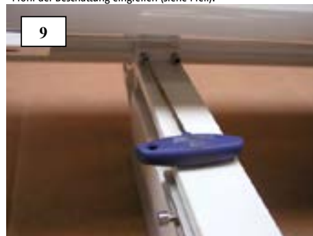
9 Sicherungsklotz an jedem Gehäusehalter unter Zuhilfenahme eines Innensechskantschlüssels Gr.6 festschrauben.
