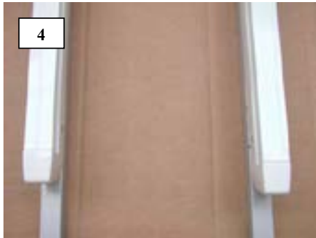
4 Ausfallseite der Führungsschiene mit Umlenkrolle und Gusskappe.
