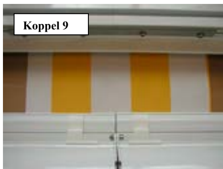
Druckplatte unterhalb des Ausfallprofils mit 4x Innensechskantschraube (Gr.5) festschrauben.
