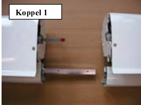
Alle Koppelbauteile sind an der Nichtantriebsseite vormontiert.
