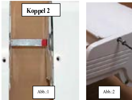
Alle Koppelbauteile sind an der Nichtantriebsseite vormontiert.
