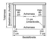
Möglicher Stützpfosten / Führungsschieneneinstand in cm, min.—max. symmetrische Aufteilung
