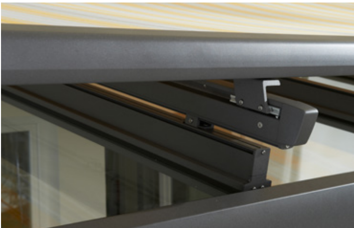
ROLLWing: Da die Führungsschienen unterhalb der Tucheiben liegen, können sie flexibel positioniert und bei der Montage bis zu 80 cm ab Aussenkante symmetrisch eingerückt werden.
